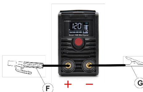
Installation pour le soudage de l'ELECTRODE ENROBEE.
