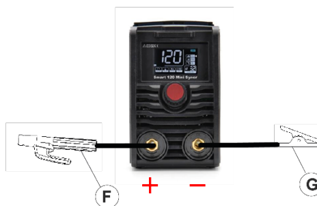
Instalação para a SOLDAGEM PULSEAR do ELECTRÓDIO REVESTIDO.
